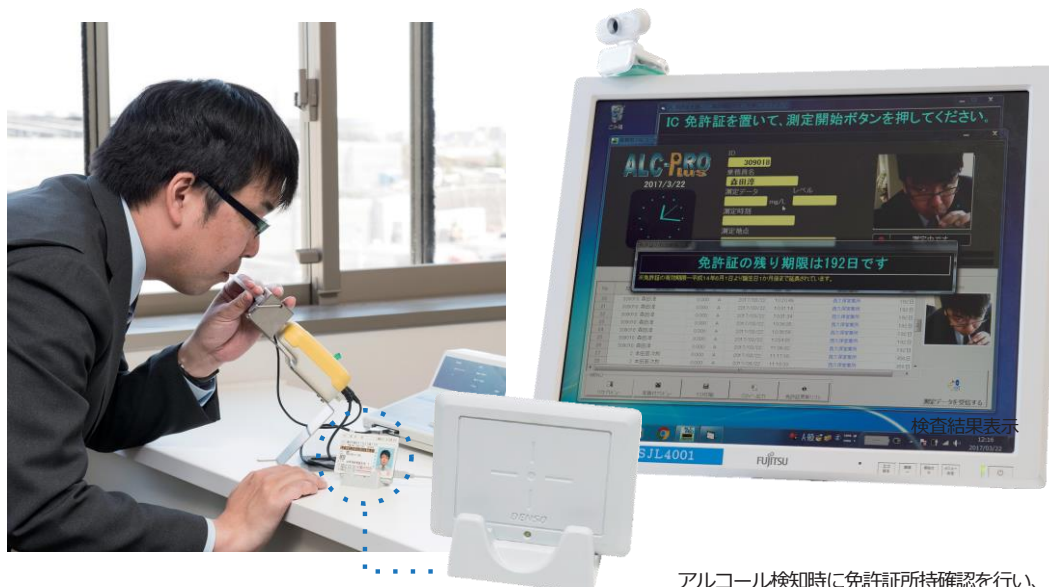
アルコール検知時に免許証所持確認を行い、免許情報により有効期限切れを防止します。
