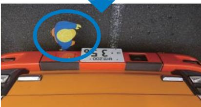
前バンパー下から子供に見立てたプレートを出し車両前方の死角の安全確認をしっかりと行っているかを確認。
