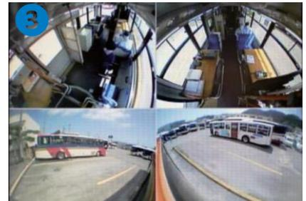
車内ミラーでは確認することができない車内の死角を天井 2 箇所に設置した車内カメラで上方からの視点で確認。バックミラーだけでは確認できない車外の車両側方の死角を車両後方 2 箇所に設置したカメラにより確認。
